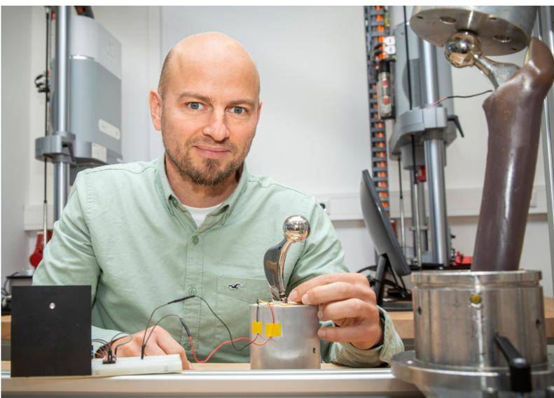
Die Hüftendoprothese wird mit einer Piezo-Keramik ausgestattet, um mechanische Energie in elektrische Energie umzuwandeln. Dr. Daniel Klüß zeigt hier den Funktionsdemonstrator der intelligenten Hüftendoprothese (Foto: Universität Rostock/Thomas Rahr).
