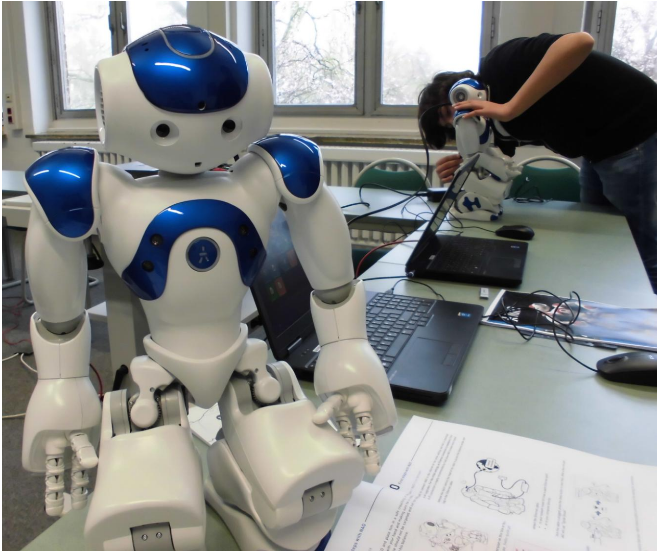
Fotonachweis: UniRostock_Sommerschule2016_NAO.jpg Rechte: Uni Rostock/Institut MD Zeigt: Inbetriebnahme eines NAO-Roboters
