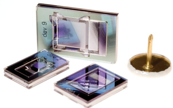
Gehäusete mikrostrukturierte Energiewandler zur Erzeugung elektrischer Leistung aus ambienten Vibrationen. Die Leistungsabgabe beträgt ca.  $100 \mu\text{W}$  bei Anregung mit typischen Vibrationen im Frequenzbereich  $50\text{-}500 \text{ Hz}$ .
