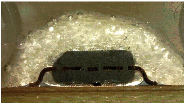
SO-8 Bauelement mit Silica-Gel-Beschichtung
