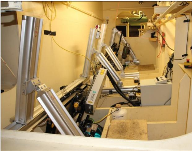
Rudermaschinenraum mit optische Zugängen und Messtechnik zur Geschwindigkeits- und Blasengrößenmessung
