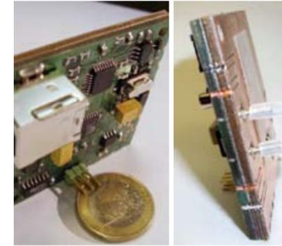
FIA in Leiterplattentechnologie, das erste „Lab-on-Board“
