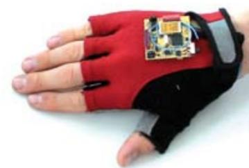
Mobile drahtlose Handschuh-Elektronik mit Sensoren und Signalaufbereitung.
